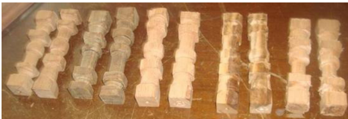
Figura 3. Corpos-de-prova depois da realização do teste de torno. Da esquerda para a direita, as espécies canela, ipê, angelim, muiracatiara e cedro, respectivamente
